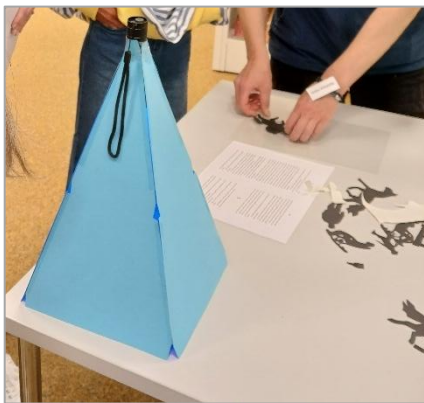
Abbildung 2: Um bei schlechtem Wetter Solarfotografie umzusetzen, nutzt man einen Kegel, der Licht von außen abschirmt und eine UV-Taschenlampe zur Belichtung
